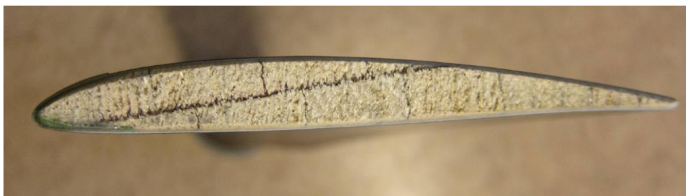
Figur 4. Genomskärning av propellerblad av typen MT
