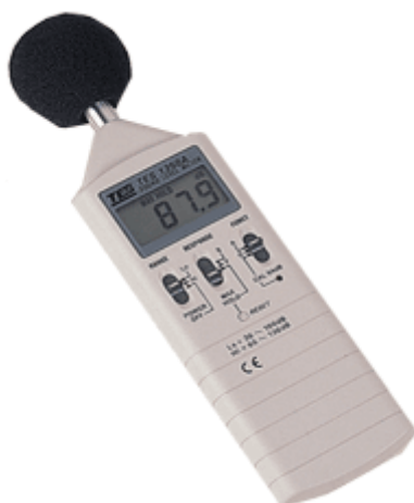
Figur 6. Ljudnivåmätare av modell TES 1350A
