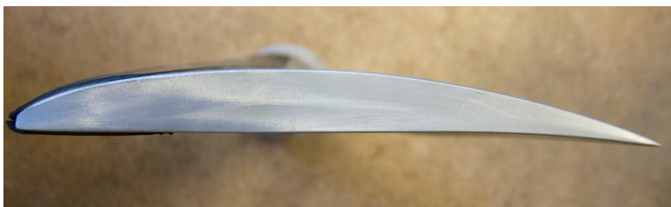
Figur 5. Genomskärning av propellerblad av typen McCauley
