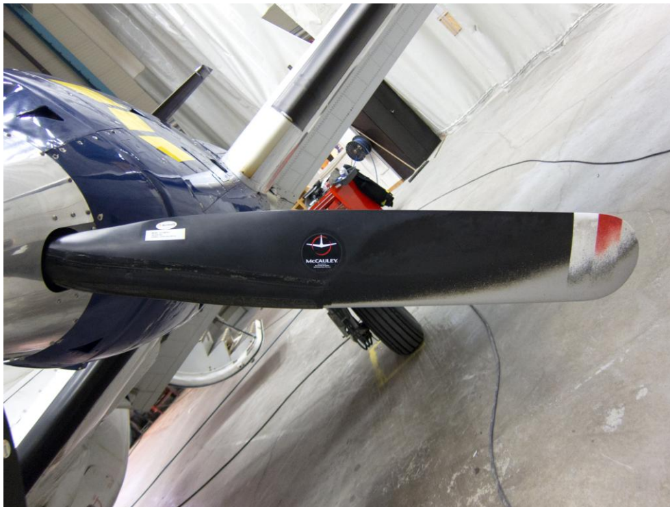
Figur 3. Propellerblad av typen McCauley
