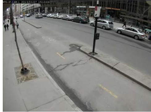
(d) Embedded inductive loops
