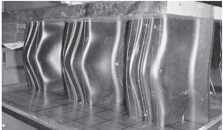
(d) Deformation of D60
